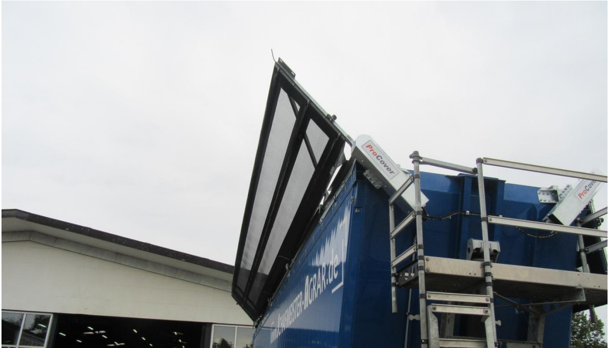
Abb.9: ProCover im Klappvorgang
